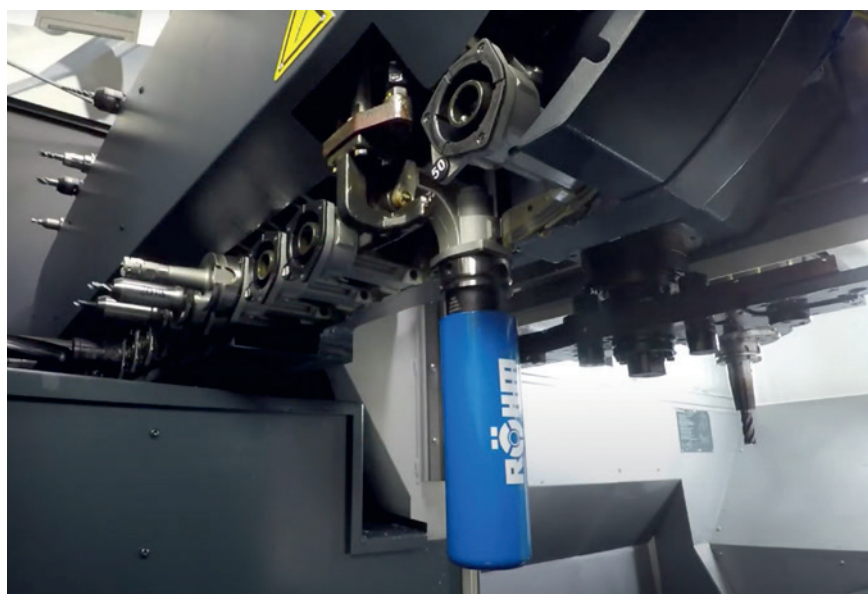
Lubritool occupa una posizione fissa nel magazzino di cambio utensile e viene impiegato ciclicamente dal programma di elaborazione
