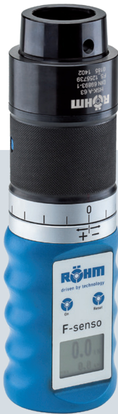
Mesure de la force de serrage avec la broche F-Senso
