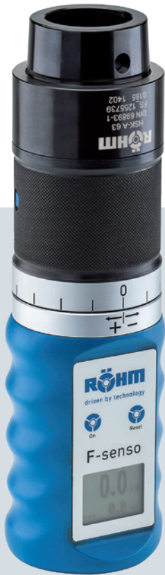
通过使用F-Senso完成夹紧力测量
