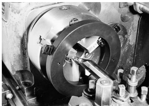
Tornitura interna di griffe non temperate
