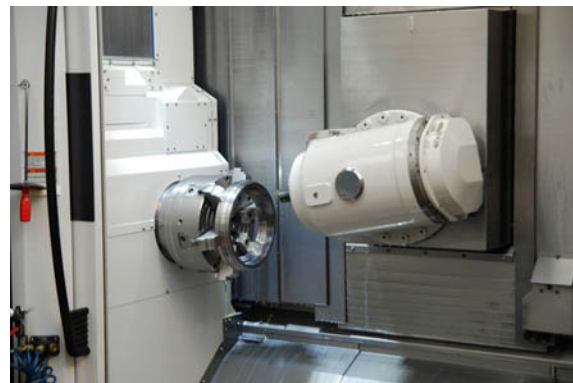
Bild Nr. 09-04 RM_EB-Maschine.jpg Neben der Auswahl geeigneter Werkstoffe erfordern metallische Gleitringdichtungen absolut präzise, maßgenaue Fertigung auf Hochleistungs-Bearbeitungszentren.
