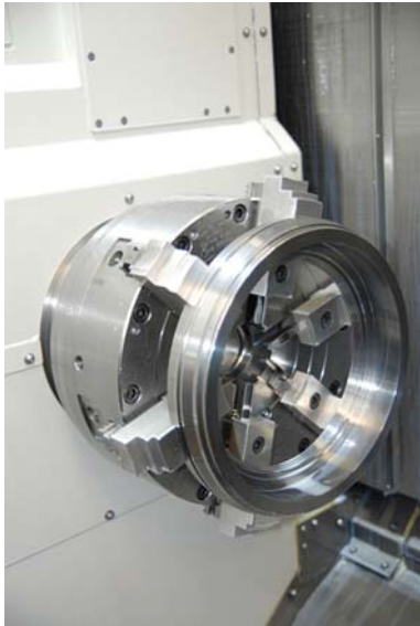
Bild Nr. 09-05 RM_EB-Futter.jpg Die dünnwandigen und leicht verformbaren Werkstücke werden bei Eagle-Burgmann sicher und formstabil gespannt dank Kraftspannfutter von Röhme.
