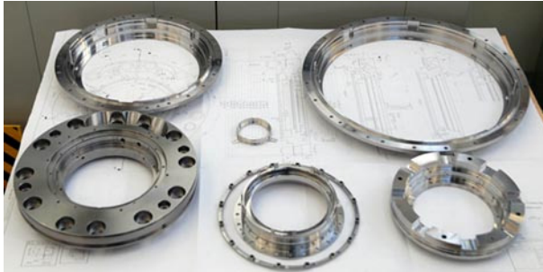
Bild Nr. 09-01 RM_EB-GR-Dichtungen.jpg Metallische Gleitringdichtungen sorgen als wichtige Bestandteile in Pumpen mit dafür, dass Öl gefördert, Kunststoff hergestellt oder Wasser über große Entfernungen transportiert werden kann.
