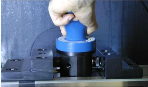
In Sekundenschnelle ist das F-senso chuck von drei auf zwei Spannungspunkte umgerüstet und kann somit auch zur Spannkraftmessung in Schraubstöcken eingesetzt werden.
