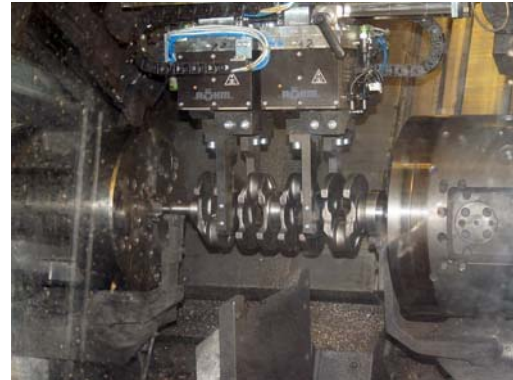
Bild Nr. 12-06 RM_FP-Beladen.jpg Die Fertigung der Kurbelwellen läuft vollautomatisiert im Mehrschichtbetrieb ab. Über Ladeportale werden die Werkstücke von einer zur nächsten Maschine transportiert.
