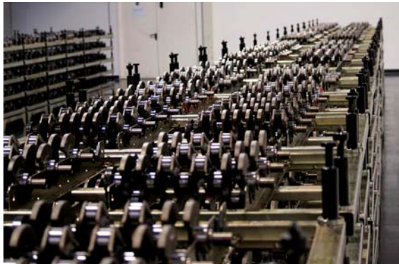
Bild Nr. 12-07 RM_FP-Versand.jpg Feuer Powertrain GmbH & Co. KG setzt auf Flexibilität und fertigt vollautomatisiert bis zu 1.800 Kurbelwellen täglich.
