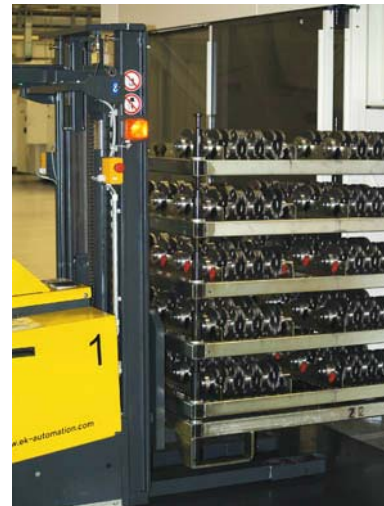
Bild Nr. 12-08 RM_FP-FTS.jpg Blick in die begehbare Absorberkammer. Zwischen einzelnen Fertigungslinien gibt es Puffer mit Werkstückträgern auf Paletten, die von frei im Raum navigierenden FTS übernommen und bereitgestellt werden.
