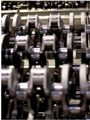
Bild Nr. 12-09 RM_FP-KW_Impression.jpg In der automatisierten Fertigung von Europas Marktführer Feuer Powertrain werden die Kurbelwellen überwiegend mit RöhM Lösungen gespannt.
