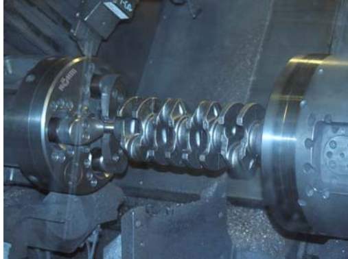
Bild Nr. 12-01 RM_FP-Kurbelwelle1.jpg Feuer Powertrain in Nordhausen spannt Kurbelwellen fast ausschließlich mit Spannlösungen von Röhm.
