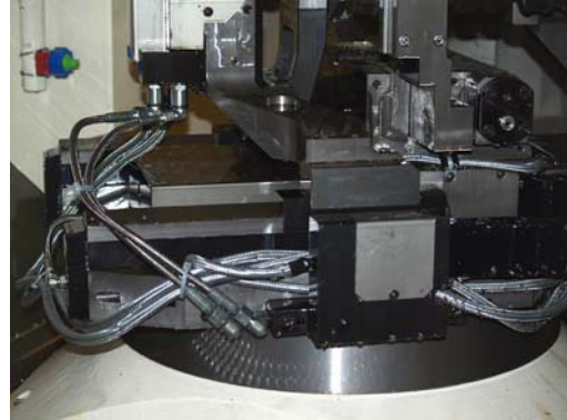
Bild Nr. 12-02 RM_FP-Vorrichtung1.jpg Dank der Röhm-Vorrichtung mit 2 integrierten NC-Achsen konnte für das Tieflochbohren bei Kurbelwellen eine Standardmaschine verwendet werden.
