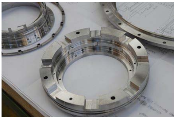
Bild Nr. 09-03 RM_EB-GR-Dichtungen3.jpg Das sichere und formstabile Spannen der dünnwandigen Werkstücke ist der zentrale Vorgang bei der Herstellung von Gleitringdichtungen.
