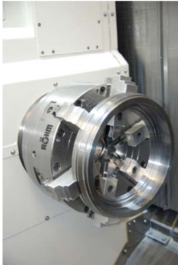
Bild Nr. 09-05 RM_EB-Futter.jpg Die dünnwandigen und leicht verformbaren Werkstücke werden bei Eagle-Burgmann sicher und formstabil gespannt dank Kraftspannfutter von Röhmmetal.
