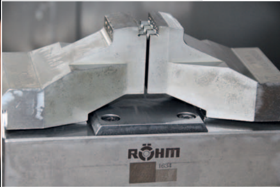
Die Backenausführungen bieten sowohl eine kraft- wie auch formschlüssige Spannung der Werkstücke mit einer Spannkraft bis zu 2000 kg.
