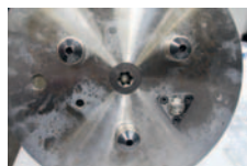
Einsatz für die Königswelle an der automatisch-mechanischen Lösung des Spannstocks von Röhm.
