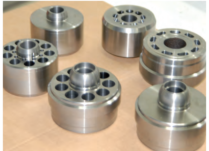
Werkstücke aus GGG 60 Sphäroguss werden mit einer einzigen Aufspannung sicher durch die Anlage geführt.
