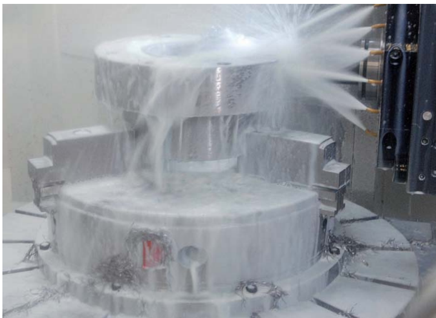
Die Rund- und Planlaufgenauigkeit des DURO-T ist doppelt so gut wie nach DIN-Genauigkeitsklasse 1 vorgeschrieben.
