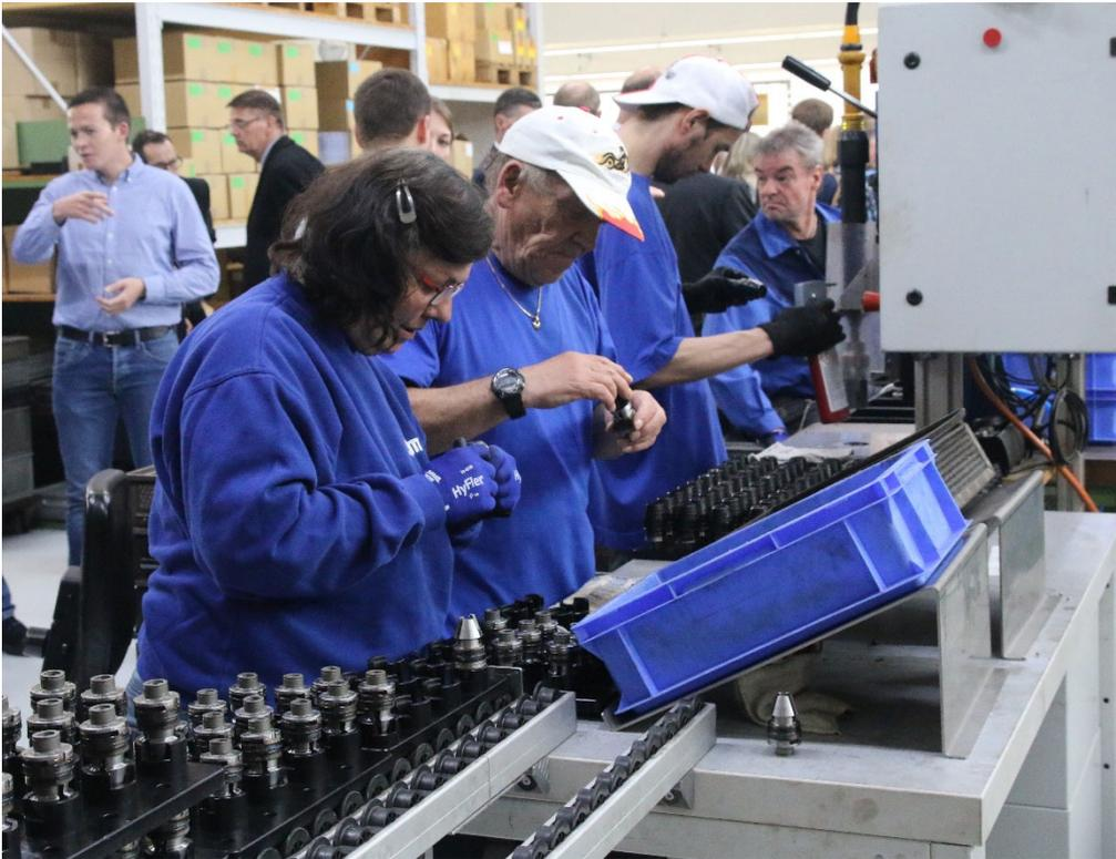
Abb. 3: Arbeitsplätze in der Bohrfuttermontage: die Tätigkeit umfasst sowohl die Montage als auch Verpackung von Röhms Bohrfuttern.
